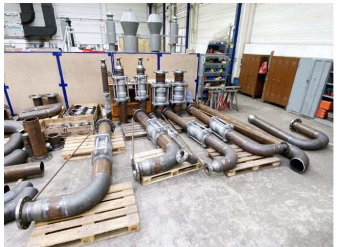
Im Werk von Herbert in Bensheim: Höchste Qualität dank Vorfertigung der Verrohrung für das Kesselhaus.
